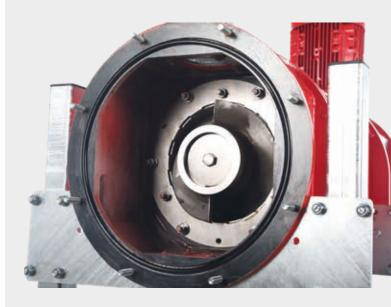
Durch die gut erreichbare Wartungsklappe ist der Zugriff auf die Pressschnecke und das Sieb jederzeit sehr einfach möglich.
