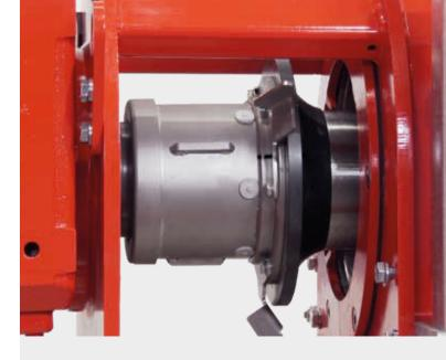
Hydraulische Verstellung VarioAdjust: Mittels Handpumpe wird der Hydraulikdruck in der Verstellung angepasst, wodurch sich der Anpressdruck dem Medium anpasst.
