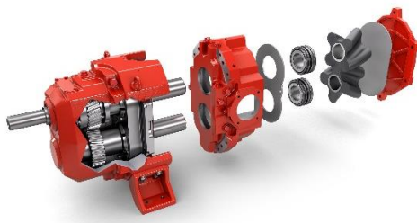
Bild 3: Explosionsdarstellung EP-Serie: Ein Hochleistungsgetriebe ermöglicht eine konstante Druckleistung von bis zu 18 bar.
