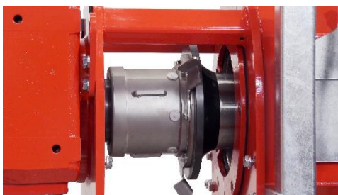
Bild 5: Detailaufnahme: Über die hydraulische Einstelleinheit und den Gegenhalter lässt sich der Anpressdruck am Separator im laufenden Betrieb flexibel einstellen – je nach gewünschtem TS-Gehalt.
