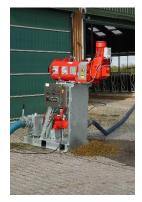
**Bild 2:** Mit dem XSplit Compact zeigt Vogelsang eine kompakte Systemlösung zur Fest-Flüssig-Trennung von Gülle und Gärresten.
