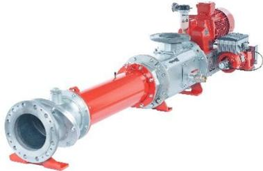
**Bild 1:** Die konische Rotor-Stator-Geometrie der HiCone ermöglicht es, den Rotor axial nachzustellen, um Verschleiß zu kompensieren.
