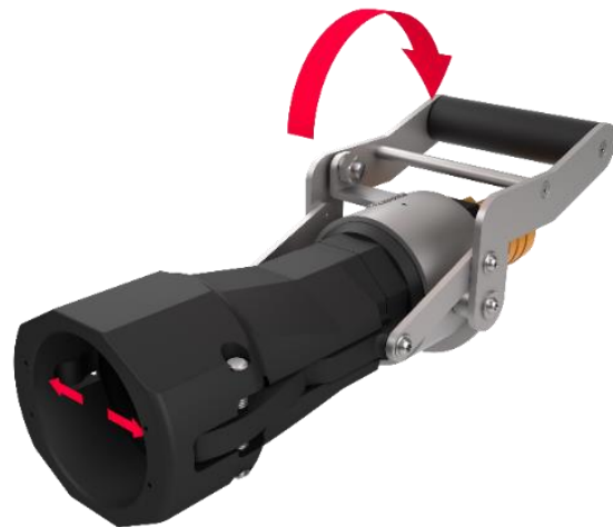
Bild 2: Beim Zurückziehen des Hebels lösen sich die kleinen Verschlüsselemente vom Tankstutzen und geben die Kupplung frei.
