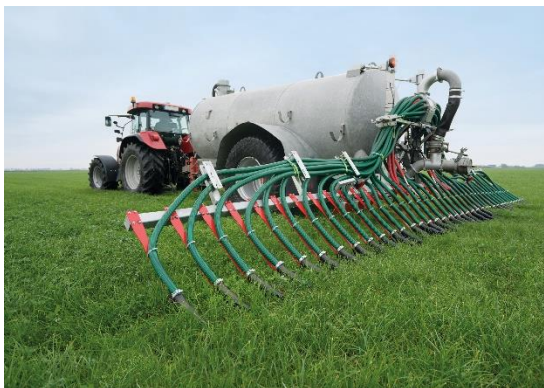
Bild 1: Das UniSpread ist kompakt gebaut und mit verschiedenen Gülleauslässen (hier: Schleppschuh) kombinierbar.
