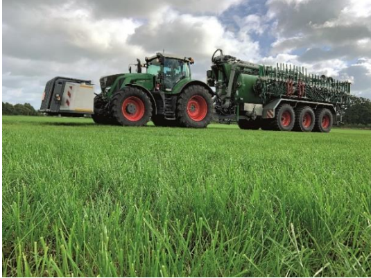
Bild 3: SyreN ist ein geschlossenes System, das die Gülle stabilisiert und Stickstoffverluste reduziert. Die zugesetzte Schwefelsäure befindet sich in einem Fronttank und wird in einer Mischkammer vor dem Ausbringgestänge in den Güllestrom dosiert.
