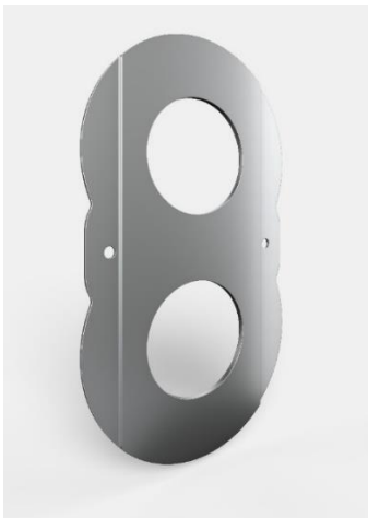
Bild 5: Pumptechnik: Die modifizierte Schutzplatte hält Faserstoffe von der Dichtung fern. Dadurch lässt sich die Standzeit der Dichtung um das Vierfache erhöhen.
