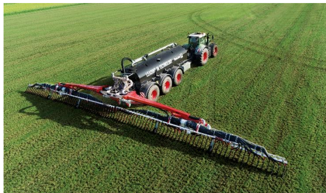
Bild 2: Auf 24 Metern Arbeitsbreite platziert das BlackBird-Schleppschuhgestänge die Gülle präzise an der Pflanze.
