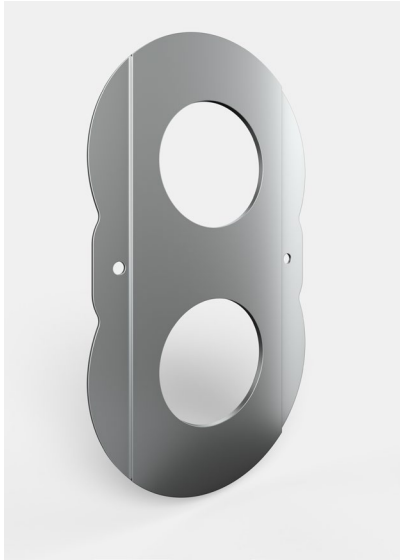
Foto 4: De nieuwe slijtplaat voor lobbenpompen van Vogelsang beschermt de afdichting tegen vezels in de stroom.
