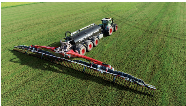
Foto 5: De BlackBird-sleepvoetbemester van Vogelsang met een lengte van 24 meter plaatst de drijfmest nauwkeurig dichtbij de bodem.
