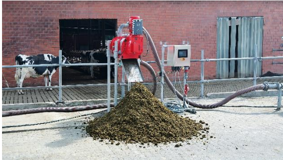
Bild 1: Vogelsang stellt den neuen Pressschneckenseparator XSplit vor, der TS-Gehalte von bis zu 40 Prozent erreicht.
